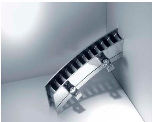
Aus dem 3D-Drucker zur Patentanmeldung: Leitschauelfsegment für eine Gasturbine von MAN Diesel & Turbo (PM_MDT_3D-Druck_1 und ..._2.jpg)
