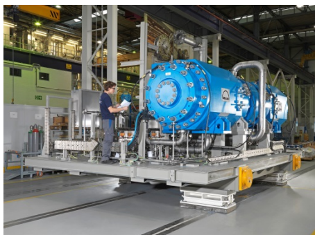
Das hermetisch-gekapselte HOFIM™ Motor-Kompressorsystem für die Ivar Aasen-Plattform
